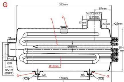
**Durchmesser der Heizelemente:** 10mm
