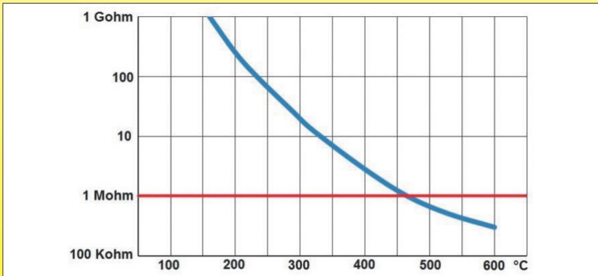
Isolierwert vs. Temperatur eines ummantelten Rohrheizkörpers mit einem Durchmesser von 8mm und einer Länge von 1200mm. (Gemessen in einem Ofen an einem zuvor getrockneten ummantelten Rohrheizkörper ohne Enddichtungen)
