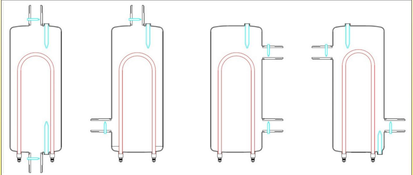
Rot: Ummantelten Rohrheizkörper. Blau: Temperatursensoren, Sonden, Schutzrohre
