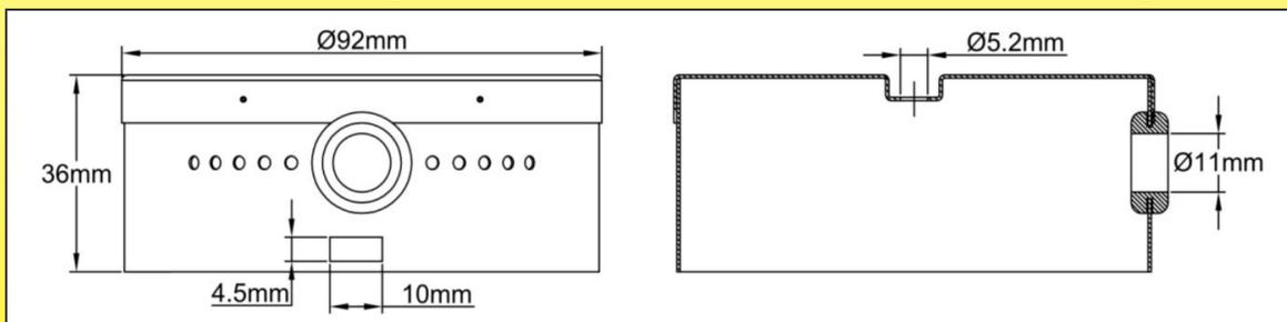
Um die elektrischen Klemmen vor Stößen zu schützen, kann optional eine Edelstahlabdeckung am Ausgangsflansch montiert werden. Sie wird mit einer Schraube und einem Haken in der Erdungsklemme befestigt. Sie bietet keinen Schutz vor Wassertropfen.
