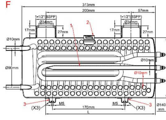
**Durchmesser der Heizelemente:** 10mm
