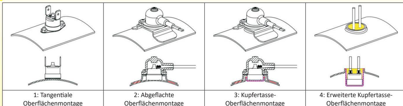
Unter normalen Betriebsbedingungen ist die Temperatur der durch den Heizkörper fließenden Flüssigkeit stabil, da sie durch einen Thermostat geregelt wird. Sicherheitsvorrichtungen wie Temperaturbegrenzer müssen nicht auslösen. Um die beste Position und Montage für Temperaturbegrenzer zu finden, ist es wichtig, ihre Reaktionszeiten bei Überhitzung zu messen.
