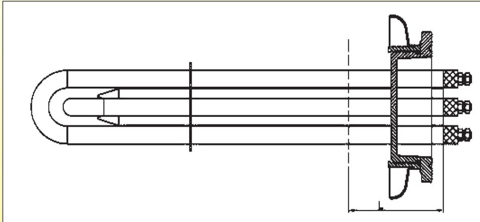
Bei professionellen Anwendungen werden Schraubverbindungen (1" bis 2½" oder M77 × 2) bevorzugt, aber die begrenzte Größe der Verbindung und ihr Durchgangs-Ø führen schnell zu Einschränkungen, wenn der Heizkörper gebogen oder gefaltet werden muss.
