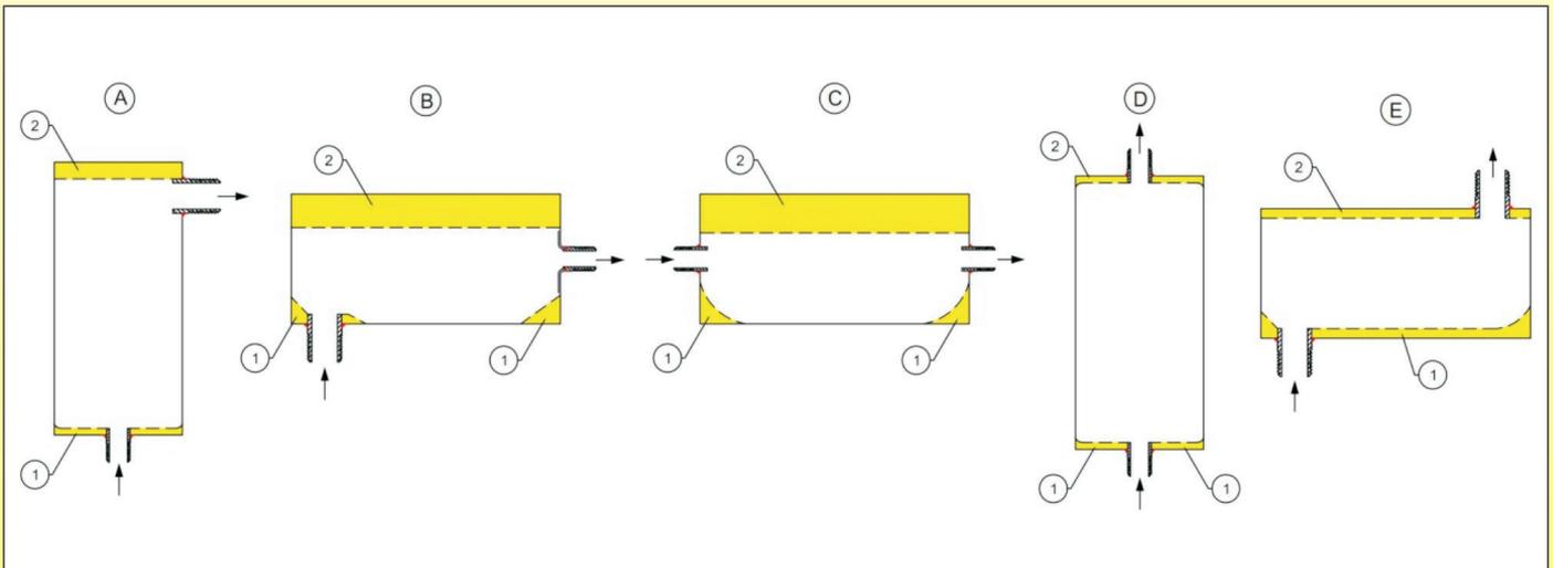
Die Bilder A, B, C, D, E zeigen falsche Designs und schlechte Installationspositionen von Heizungen mit Bereichen, wo sich **Schlamm ablagert** (1) oder **Luft ansammelt** (2), sowie scharfe Kanten im Inneren, die die Ansammlung von Partikeln begünstigen.
