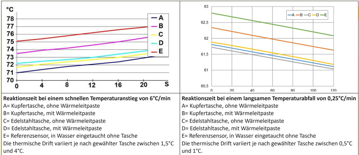
Schutzrohre mit einer Länge von 100mm und einem Innen-Ø von 6mm, ausgestattet mit einem Pt100-Widerstandstemperatursensor mit Ø5mm. Die Wandstärke des Rohrs beträgt 1mm bei Kupfer und 0,5mm bei Edelstahl. Die Schutzrohre werden nebeneinander im selben Wasserstrom platziert. Die bevorzugten Lösungen in diesem Katalog sind Schutzrohre aus Edelstahl 304L oder 316L mit einem Abstand von 0,5mm zum Messelement und Wärmeleitfett.
