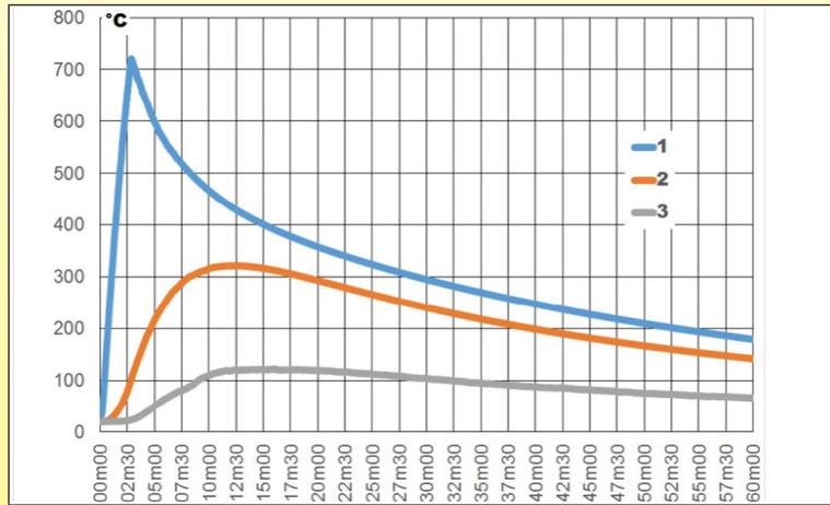
Tests an einem Flüssigkeitserhitzer von Ø125mm, mit 3 Rohrheizkörpern von je 2kW, Oberflächenlast 5W/cm<sup>2</sup>, mit 20mm Wärmeisolierung aus NBR-PVC-Schaum und aluminisiertem Mantel. 122°C-Thermoschutzschalter.
