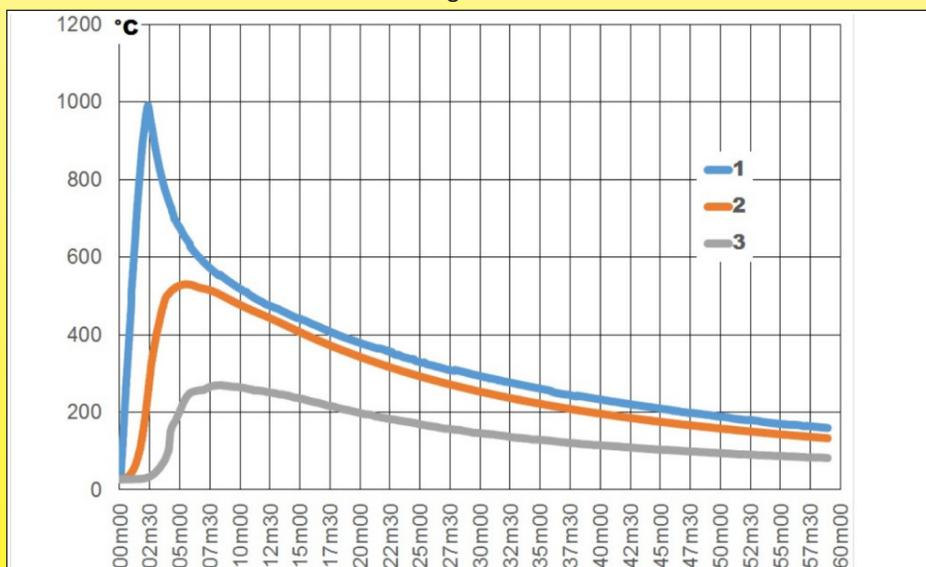
Die Tests wurden an einem Flüssigkeitserhitzer von Ø125mm mit 3 Rohrheizkörpern von je 2kW, einer Oberflächenlast von 10W/cm<sup>2</sup>, einer 20mm Wärmeisolierung aus NBR-PVC-Schaum und einem aluminieren Mantel durchgeführt. **Die Temperatur der Tankwand steigt auf über 520°C. Unter diesen Bedingungen entzündet sich der Schaum in weniger als 3 Min.**
