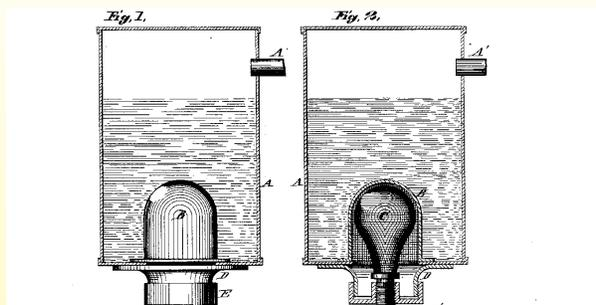
1889 meldete Daniel Smith aus St. Louis (Missouri, USA) ein Patent für einen elektrischen Warmwasserspeicher an, dessen Erhitzung durch einen Platindraht in einem Glaskolben unter einer Schutzkuppel erfolgt (US-Patent 411737). Obwohl dieses Patent ungenutzt blieb, kann es als Vorläufer der elektrischen Warmwasserbereiter angesehen werden.
