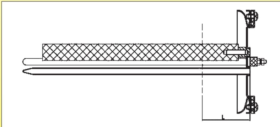
Die Montage auf einem gestanzten Flansch ist eine kostengünstige Lösung für einen abnehmbaren Heizkörper, da sie große Durchmesser sowie die Installation von Magnesium-Opferanoden ermöglicht. Der Heizkörper kann leicht aus dem Tank entfernt werden, um ihn zu reinigen, Schlamm und Kalk zu entfernen und die Anode auszutauschen.
