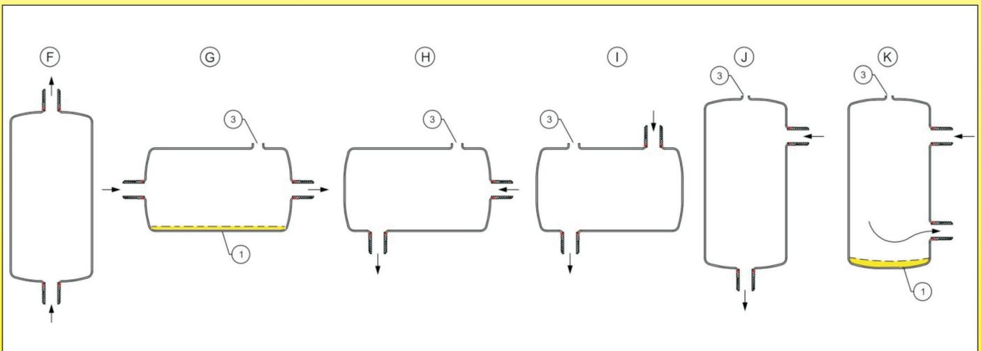
Die Zeichnungen F, H, I und J zeigen Designs mit abgerundeten Winkeln. Lufteinschlüsse werden durch die Position (F) oder durch das Vorhandensein einer Entlüftungsöffnung (3) vermieden. Schlammablagerungen werden vermieden, wenn die Fließrichtung beachtet wird. Die Zeichnungen G und K zeigen ein Risiko für Schlammablagerungen und erfordern möglicherweise ein Abflussloch am untersten Teil (1).
