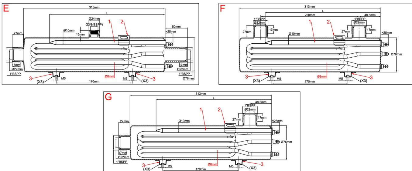
**Durchmesser der Heizelemente:** 8mm
