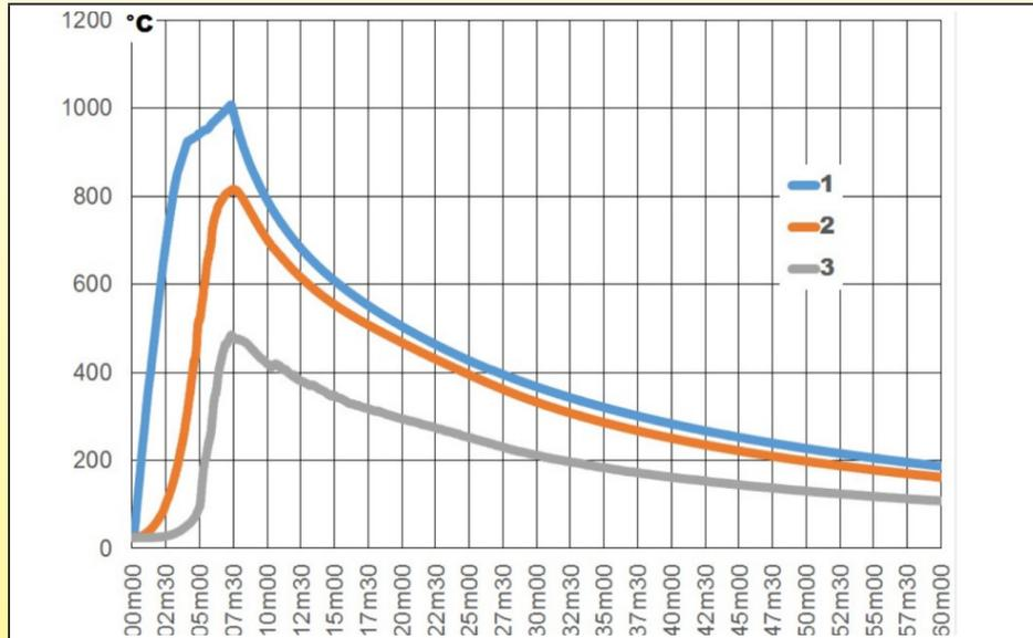
Die Tests wurden an einem Flüssigkeitserhitzer von Ø125mm mit 3 Rohrheizkörpern von je 1kW, einer Oberflächenlast von 5W/cm<sup>2</sup>, einer 20mm Wärmeisolierung aus NBR-PVC-Schaum und einem aluminieren Mantel durchgeführt. **Die Temperatur der Tankwand steigt auf über 800°C. Unter diesen Bedingungen entzündet sich der Schaum in weniger als 7 Min. (6 Min. 50 Sek.)**
