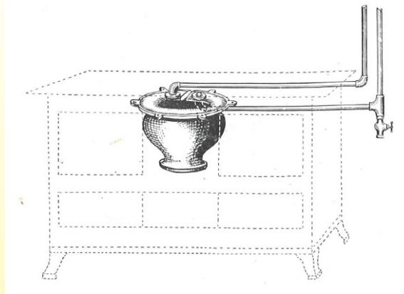
Wärmetauscher "Bouilleur", der in einem Ofen montiert ist (Katalog von Ets Demoulin, Farciennes, 1932, Ultimheat Museum)
