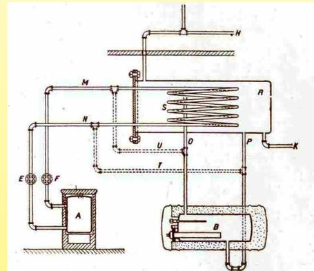
1927: Kohle-elektrische Wassererwärmung mit doppelter Energiequelle, Etelec, mit Röhrenwärmetauscher in einem Speichertank. (Ultimheat Museum)
