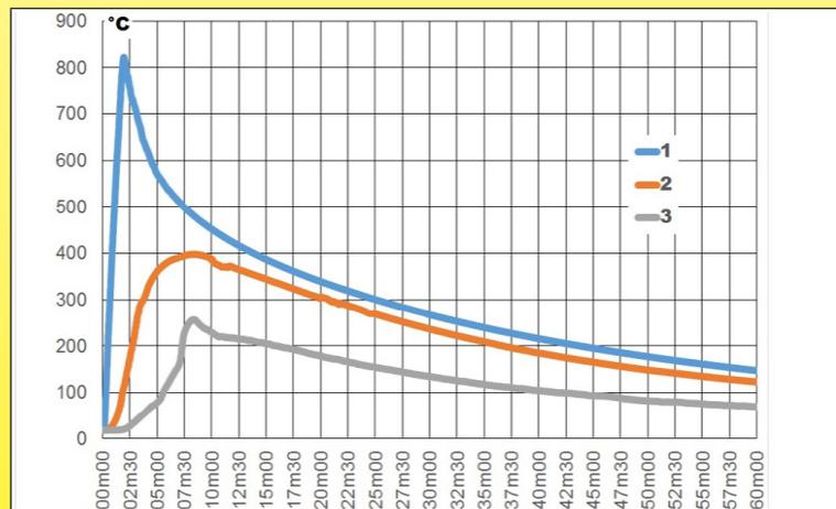
Tests an einem Flüssigkeitserhitzer von Ø125mm, mit 3 Rohrheizkörpern von je 2kW, Oberflächenlast 10W/cm<sup>2</sup>, mit 20mm Wärmeisolierung aus NBR-PVC-Schaum und aluminisiertem Mantel. 122°C-Thermoschutzschalter.
