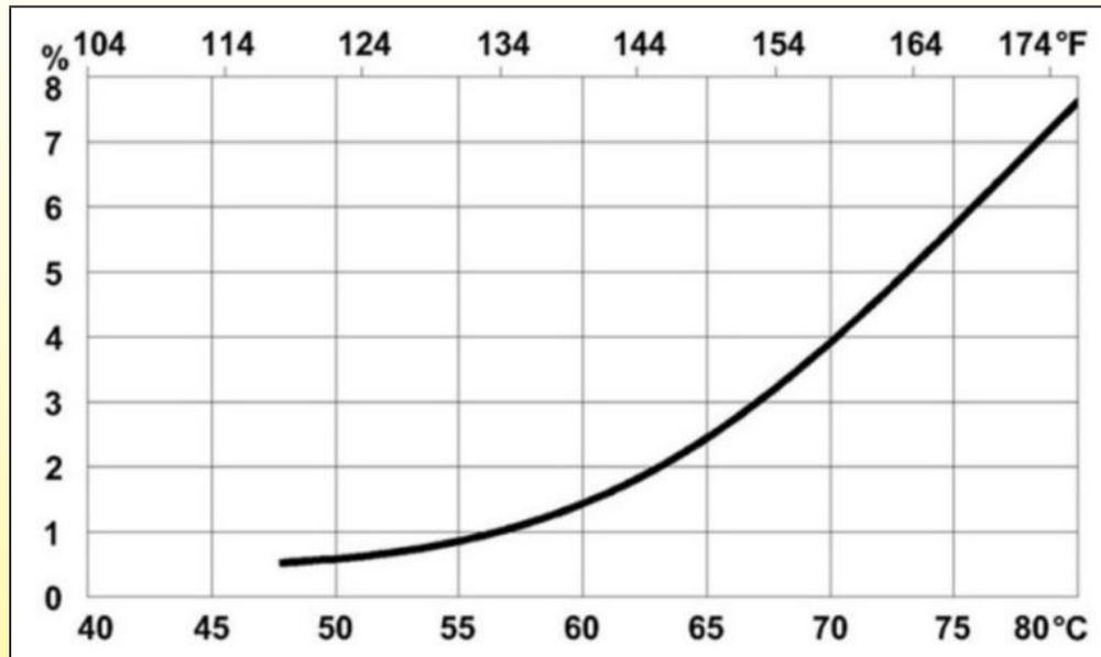
Diese Abbildung zeigt den geschätzten Prozentsatz der im zirkulierenden Wasser gelösten Mineralsalze, die sich bei Kontakt mit den heißen Wänden des Rohrheizkörpers ablagern.
