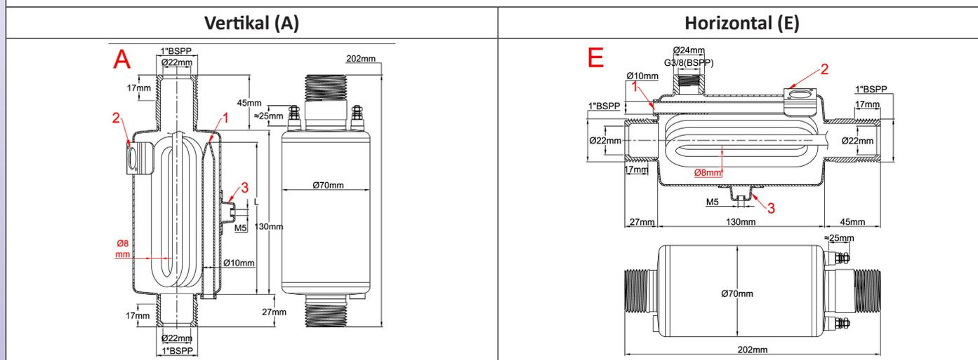
**Durchmesser des Heizelements:** 8mm
