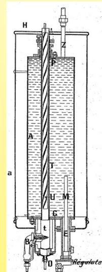
1913 entwickelten die Firmen Ets Grouvelle und Arquembourg in Paris den ersten Gas-Warmwasserspeicher mit Temperaturregler. "The Marseillais"
