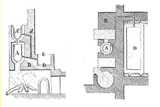
Badezimmerheizungen mit Tanks zur Warmwasserspeicherung und mit Kaltwasserzulauf und Warmwasserablauf waren in Italien bereits in der Römerzeit bekannt und wurden verwendet.
