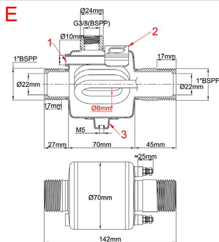
**Durchmesser des Heizelements:** 8mm
