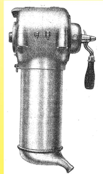
1922 entwickelte die Firma Presto in Paris einen Durchlauferhitzer, der an einem Wasserhahn montiert wird und bei dem das Wasser durch seine eigene Leitfähigkeit erhitzt wird, ohne Heizdrähte. Diese technische Lösung, die standardmäßig sehr empfindlich auf die Wasserqualität reagiert, wird immer noch zur Dampferzeugung in Maschinen zum Entfernen von Tapeten und ähnlichen Geräten verwendet. (Dokumente des Ultimheat-Museums)
