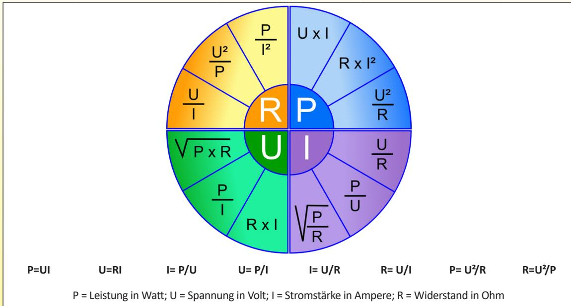
**M - 2 Tabelle der Leistung in Watt einer elektrischen Heizung vs. Widerstand und Spannung an den Klemmen**
